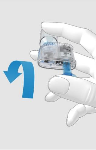
Capovolgi l'unità serbatoio con il flacone d'insulina in modo che il flacone si trovi sopra il serbatoio. Durante questa operazione accertati di tenere il pollice sotto l'impugnatura affinché l'aria rimanga nel flacone.
