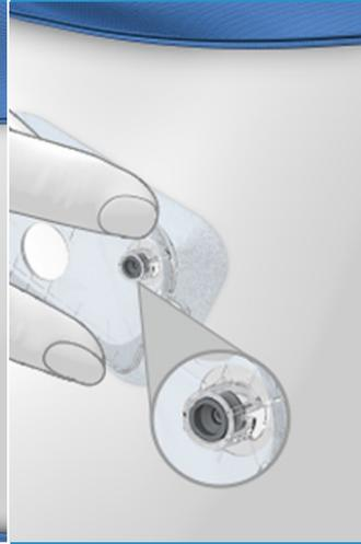
**Ora, verifica che la testina grigia della cannula sia visibile nel foro di giunzione della cannula e a filo con il foro.** Se la testina grigia della cannula non è visibile, consulta [\(Sistema di microinfusione Accu-Chek Solo\) Capitolo 18.7 Soluzione di eventuali problemi.](#)
