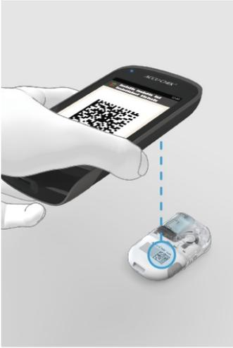
Punta la fotocamera presente sul retro dello strumento di gestione del diabete verso il codice di associazione riportato sulla base del microinfusore. Tieni lo strumento di gestione del diabete in modo che il codice di associazione appaia al centro del display.
