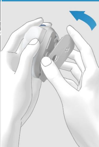
Ensuite, en exerçant une légère pression, enfoncez le support de pompe intégralement dans le dispositif d'insertion jusqu'à ce qu'il s'enclenche dans l'ergot en face du dispositif d'insertion.
