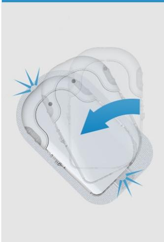
Après un huitième de tour (environ 45 degrés), la micropompe s'engage dans les ergots avant et arrière du support de pompe.
